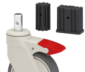
Pemasangan cepat dan mudah dengan adaptor plastik yang mudah dipasang pada pipa kaki ranjang. Tersedia dalam bentuk bulat (ø27,3mm, ø28,5mm, ø29,3mm, ø35,5mm, dan ø39mm) dan bentuk segi empat (27mm x 57mm dan 36 x 36mm). Hanya berlaku untuk kastor dengan akhiran SF20.
