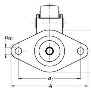
Top Plate dengan 2 lubang pengepasan
