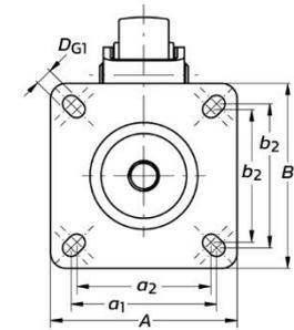
Top Plate Persegi dengan 4 lubang pengepasan
